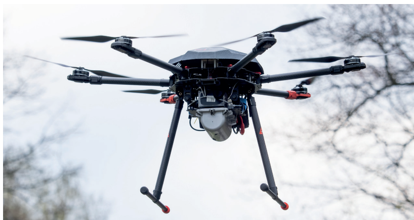
Fot. 6. Dron NCBJ wyposażony w detektor promieniowania jonizującego podczas przelotu na terenie ośrodka jądrowego Świerk (fot. NCBJ)
