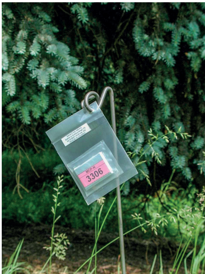
Fot. 5. Pomiary mocy dawki w środowisku za pomocą pasywnych dawkomierzy TLD (fot. IFJ)
