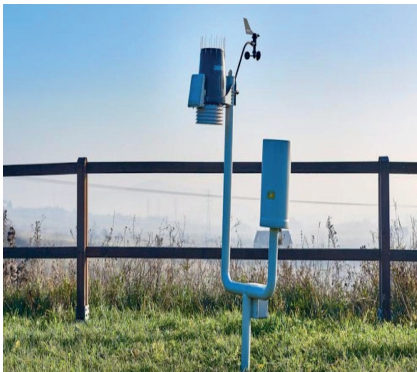
Fot. 1. Stacja pomiarowa systemu wczesnego wykrywania skażeń promieniotwórczych do oceny bieżącej sytuacji radiacyjnej w kraju, jak również sytuacji w przypadku zdarzenia radiacyjnego (fot. PAA)
