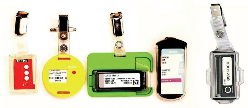
Fot. 7. Dozymetry pasywne stosowane do oceny narażenia personelu na promieniowanie jonizujące w ramach tzw. dozymetrii indywidualnej (fot. IMP)
